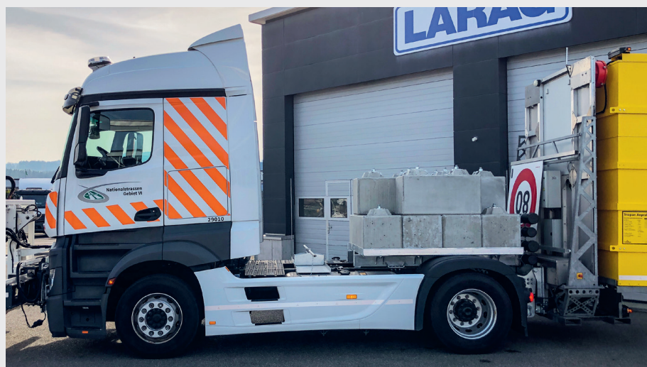
SwissBlock®-TEC kraftschlüssig mit Fahrgestell verschraubt.
